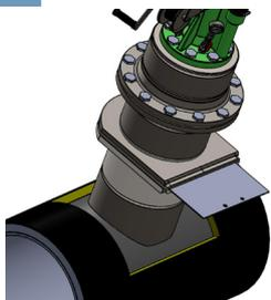
⚠ Wenn sich Staub in der Rinne der Sperrscheibe angesammelt hat, reinigen Sie die Dichtungen SORGFÄLTIG mit Reinigungsmesser.
